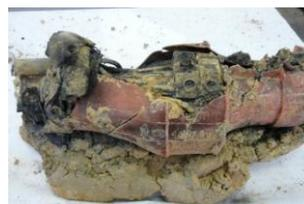
**Fig. 1 :** Resin not correctly poured
