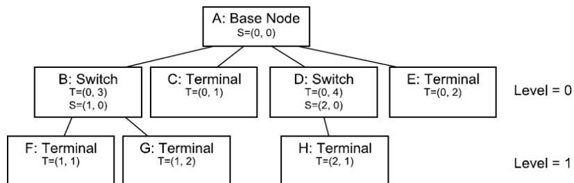
Figure 4—12: PLC PRIME tree example
